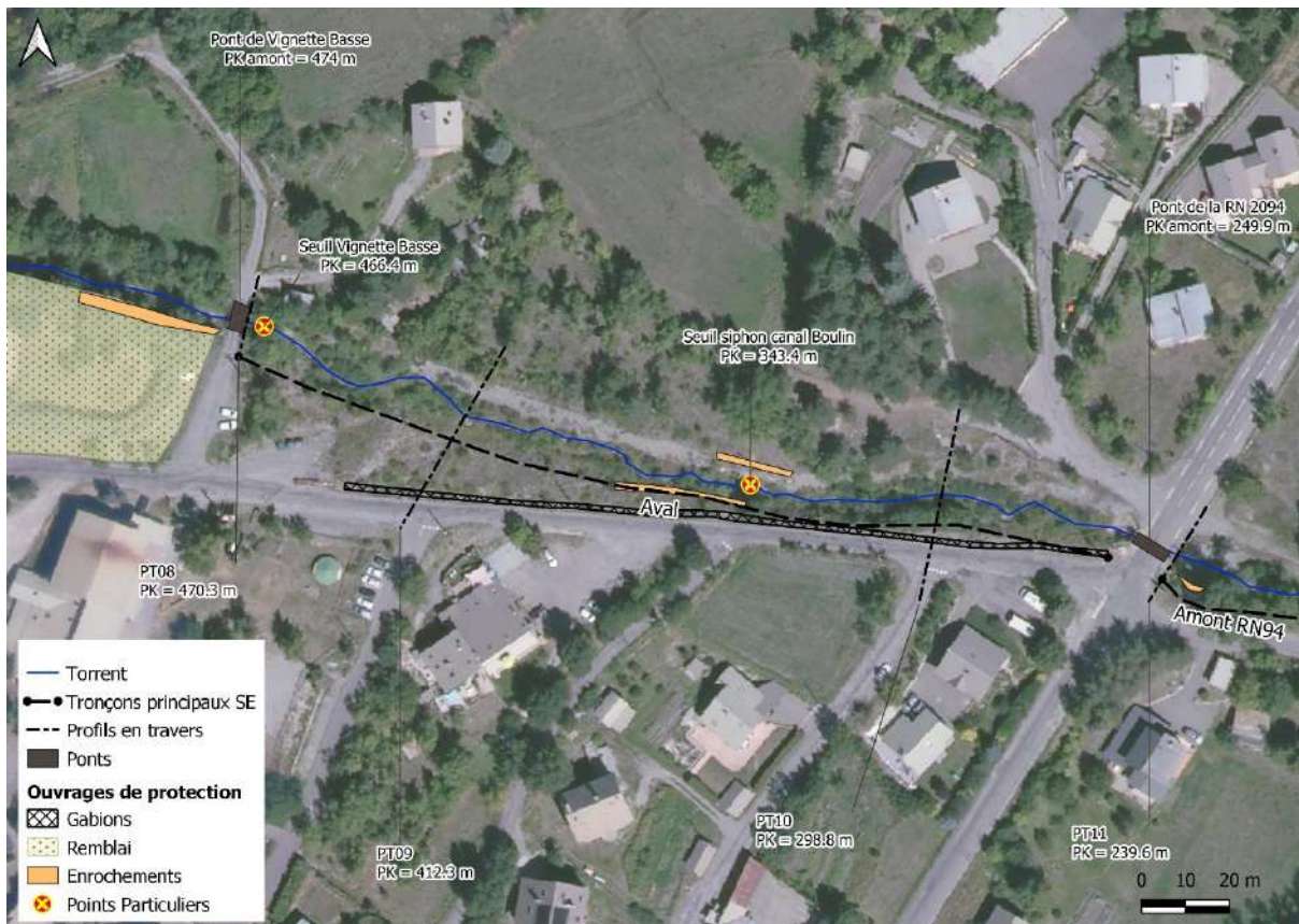
Figure 91 : Vue en plan du tronçon aval
