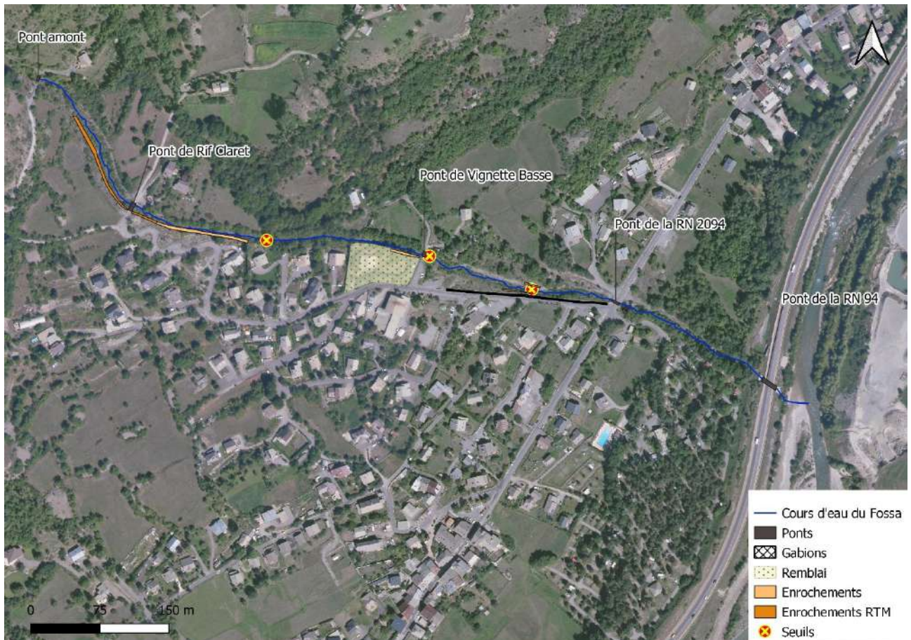
Figure 32: Localisation des ouvrages complémentaires
