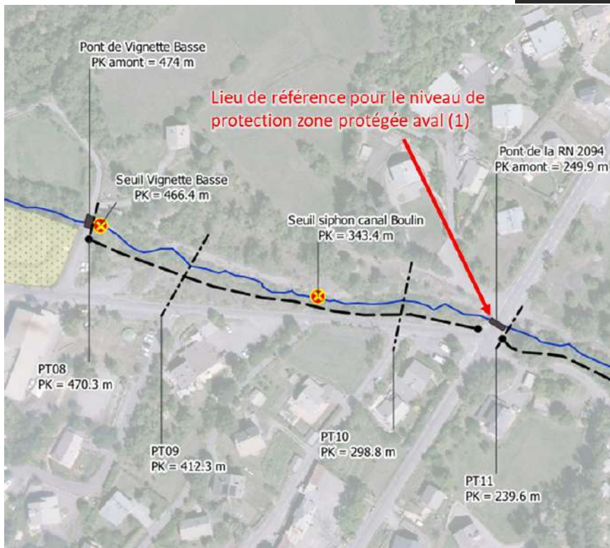
Figure 158 : Localisation du lieu de référence pour le niveau de protection de la zone protégée aval (1)
