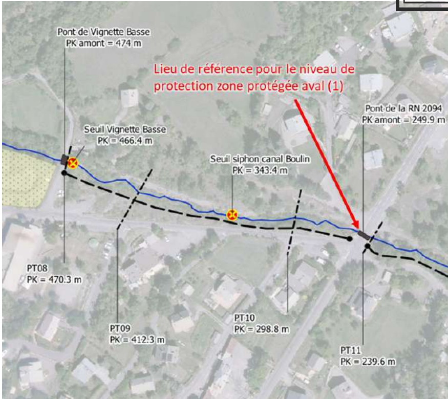
Figure 17 : Localisation du lieu de référence pour le niveau de protection de la zone protégée aval (1)
