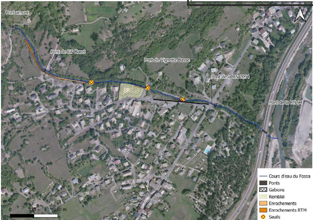
Figure 104: Localisation des ouvrages complémentaires
