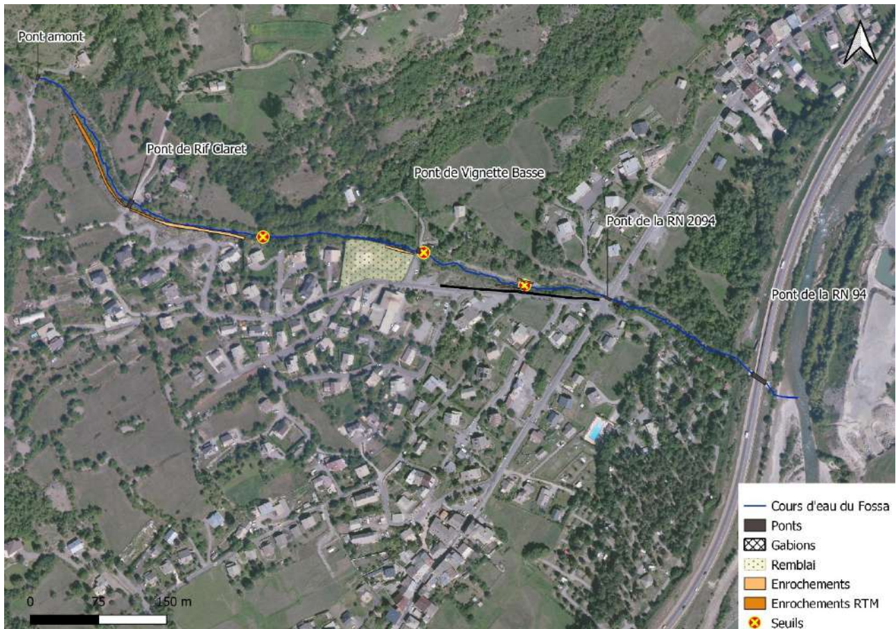
Figure 4: Localisation des ouvrages complémentaires
