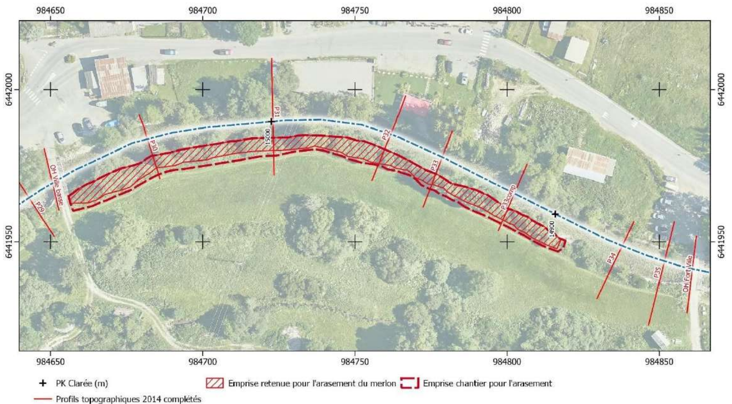
Figure 75 : Emprise maximale du chantier d'arasement
